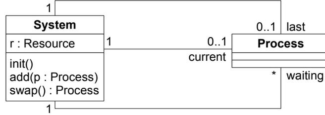
L'opération **init()** met le système dans un état initial où il n'existe aucun processus. L'opération **add(p : Process)** ajoute un processus au système. S'il n'existe aucun processus, **p** devient le processus courant qui détient la ressource, sinon il est ajouté à **waiting**. L'opération **swap()** change le processus actif qui détient la ressource.
